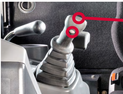
1 P.T.O hold button potentiometer
