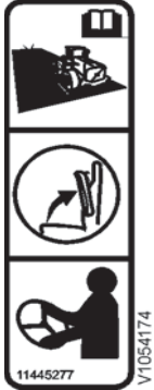
27 Gebruik joystickbesturing (CDC) op de openbare weg verboden – stuurwiel gebruiken.
