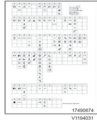
29 Zekeringen en hun functies (aan de binnenkant van het deksel)
