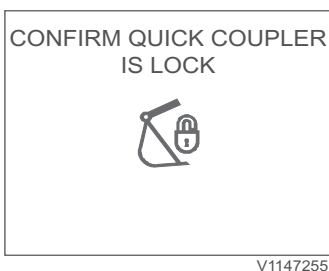
Vergrendeling van snelwissel bevestigen
