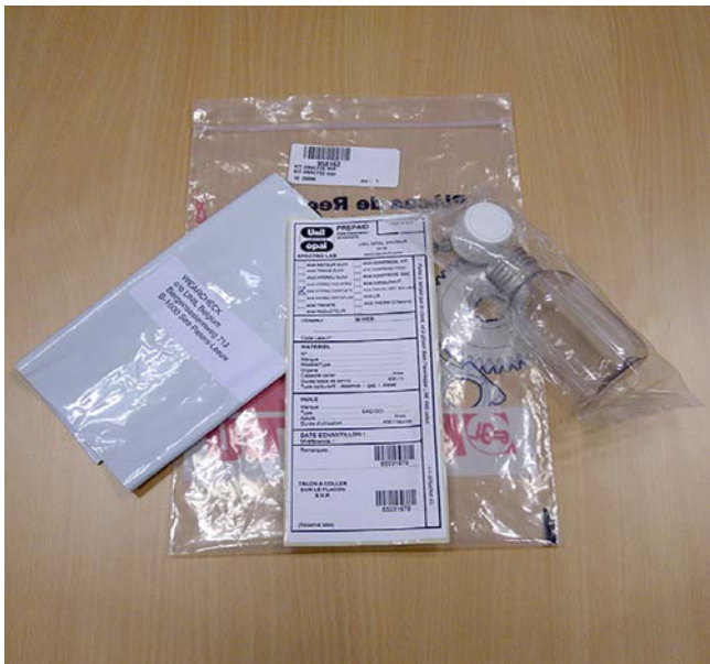
Afbeelding 173: Op vervuiling van de hydraulische olie controleren
