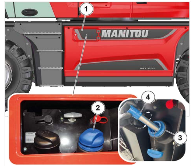
Figure 226: Vérification et nettoyage du filtre de remplissage du réservoir de DEF
