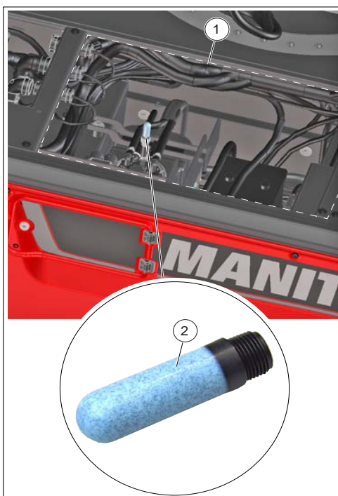
Figure 205: Remplacement du reniflard du réservoir de « DEF »
