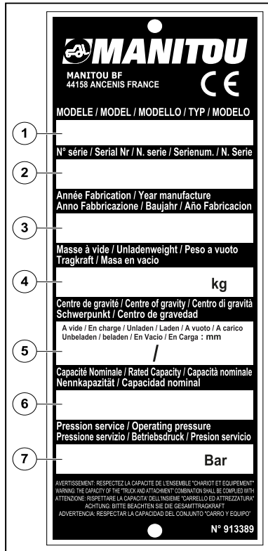
Figure 26: PLAQUE DU FABRICANT DE L'ACCESSOIRE
