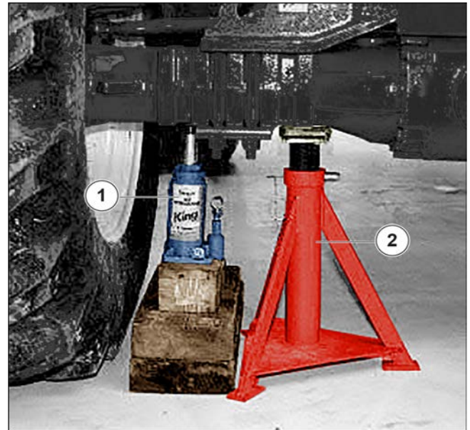
Afbeelding 212: Een wiel vervangen
