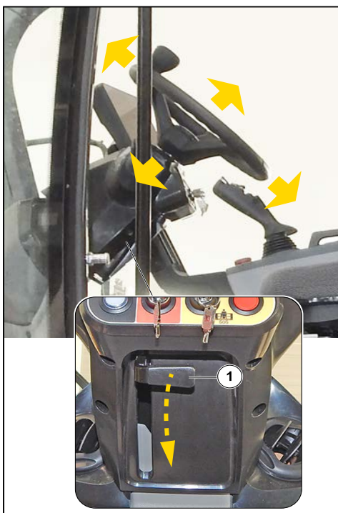
Afbeelding 53: Het stuurwiel afstellen
