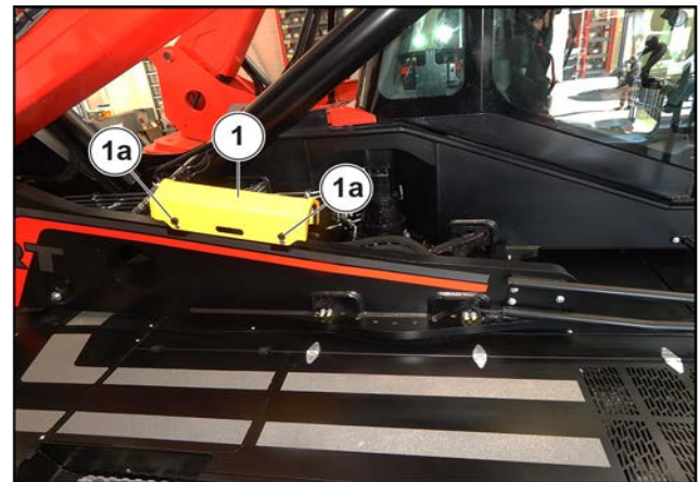
Figure 67: Cale de sécurité de la flèche
