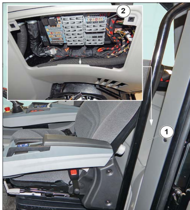
Figure 214: Fusibles et relais dans la cabine
