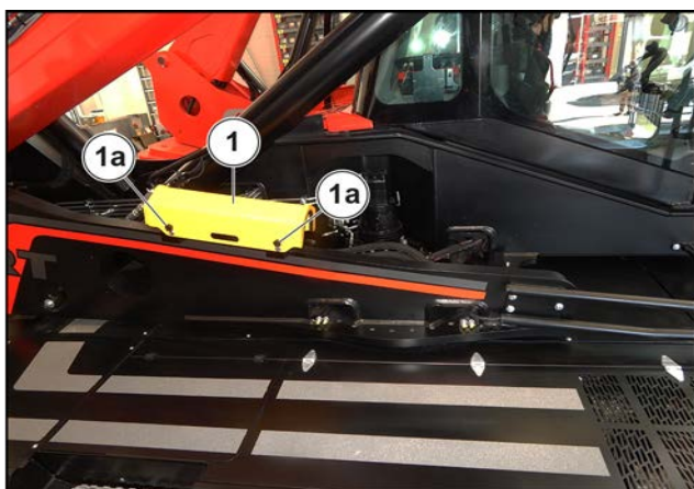
Figure 210: Cale de sécurité de la flèche
