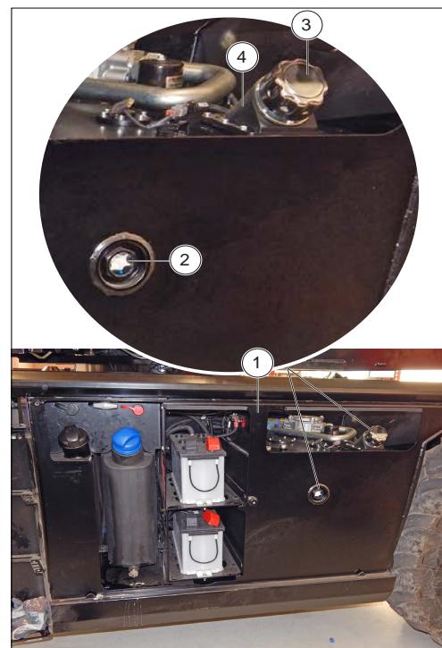
Figure 153: Vérification du niveau d'huile hydraulique
