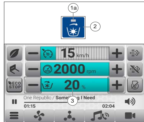
Figure 127: Mouvement hydraulique continu de l'accessoire
