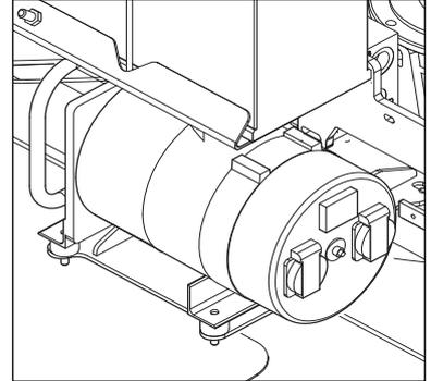
Utiliser l'interrupteur situé sur le pupitre panier pour activer la génératrice.
