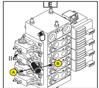
**Pour lever et descendre le bras supérieur (positionner le levier sur III).**
