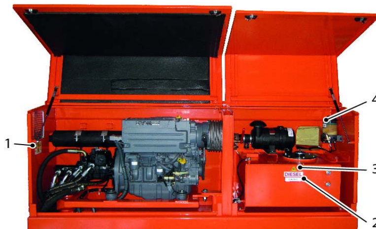
Compartiments du moteur diesel et du système de graissage centralisé
