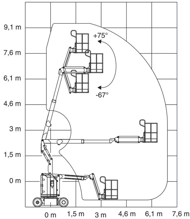
**Amplitude de mouvement du bras pendulaire rotatif**
