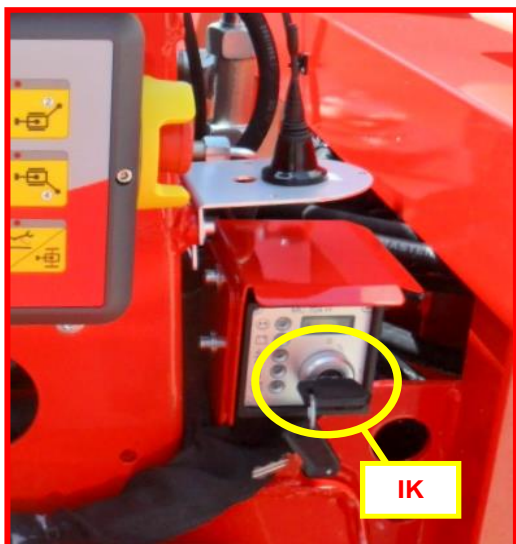
Figure 4 : poste pour marche/arrêt du moteur.
