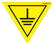
Figure 84 : mise à la terre.
