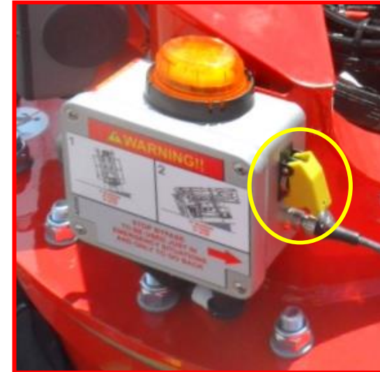
Figure 24 : bouton de by-pass de blocage de translation.
