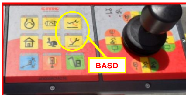
Figure 27 : boutons stabilisation/déstabilisation automatique sur console de la nacelle.
