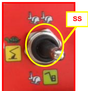
Figure 22 : sélecteur de vitesse sur radiocommande.
