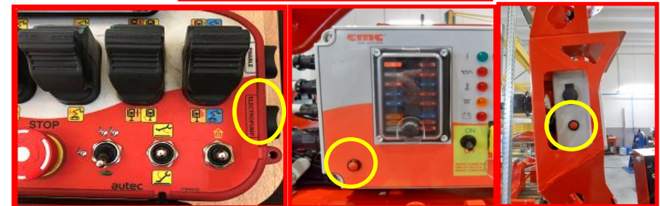
Figure 62 : activation de l'électropompe (*en option).
