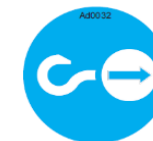
Figure 96 : points d'attache pour soulever PEMP.
