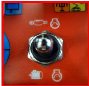
Figure 7 : levier marche/arrêt du moteur à combustion interne/électrique sur la radiocommande.
