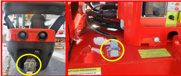
Figure 17 : branchement de la télécommande filaire.
