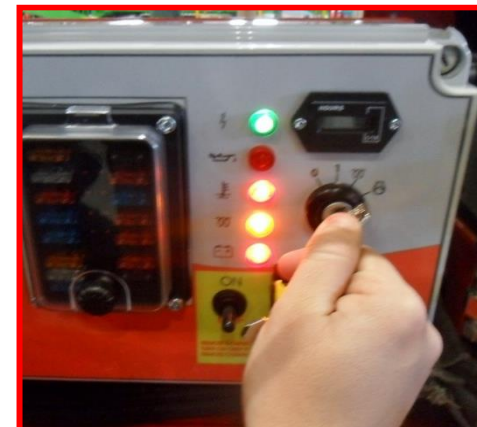
Figure 5 : phase de chauffage des bougies du moteur.
