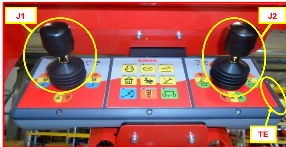
Figure 9 : poste de commande plateforme dans nacelle.
