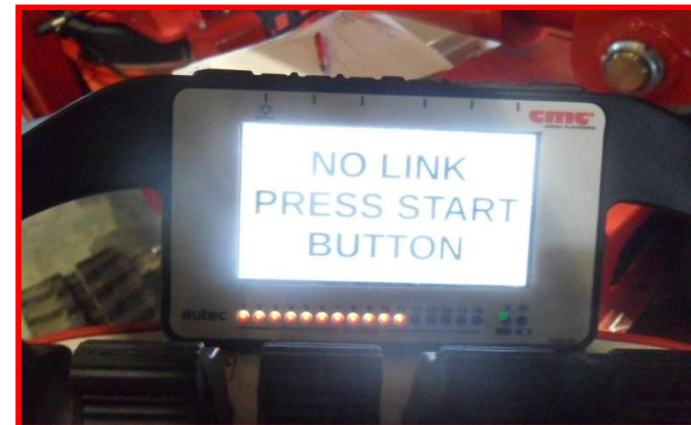
Figure 15 : avertissement de la radiocommande non connectée.
