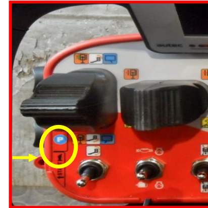
Figure 51 : bouton P de stationnement pour contourner le système anticollision.
