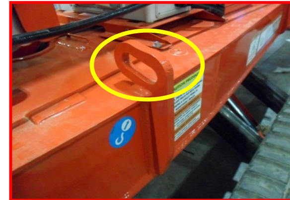
Figure 41 : crochets sur le châssis.
