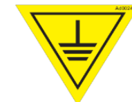
Figure 75 : mise à la terre.
