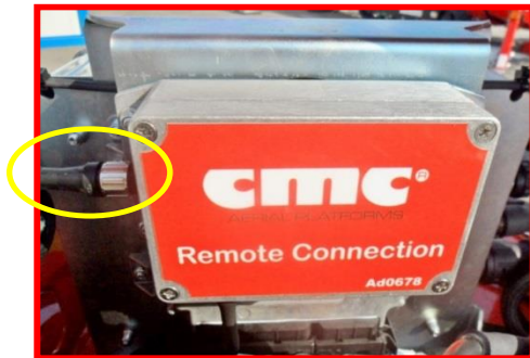
Figure 86 : Boîtier de connexion à distance.
