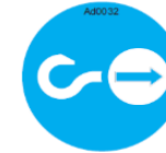
Figure 62 : points d'attache pour soulever PEMP.
