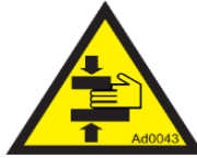
Figure 77 : danger d'écrasement et de cisaillement.
