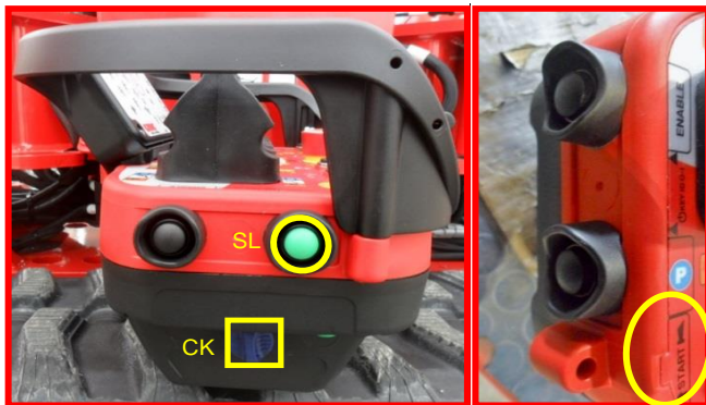
Figure 8a : clé de contact et bouton de liaison de la radiocommande.
