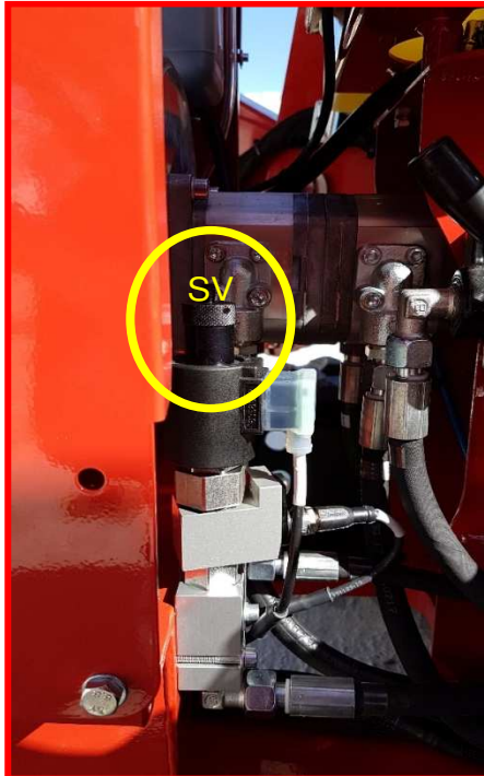
Figure 27 : vanne des stabilisateurs.
