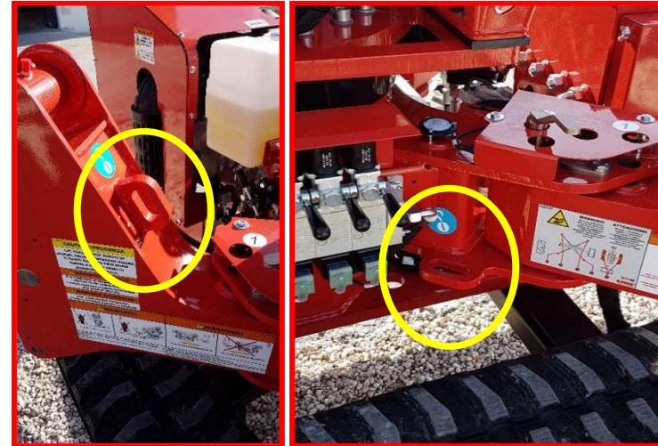
Figure 16 : crochets sur le châssis pour élinguer la PEMP.
