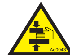
Figure 84 : danger d'écrasement et de cisaillement.
