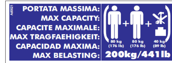
Figure 38 : charge maximale dans la nacelle.
