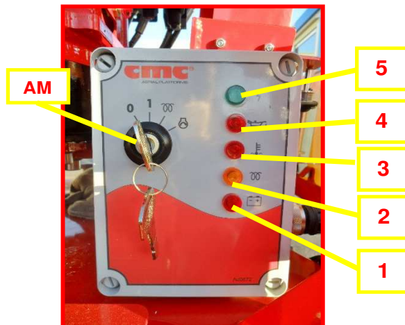
Figure 4: poste de marche/arrêt Kubota.
