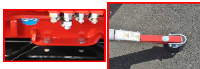
Figure 12 : crochets pour élingage.
