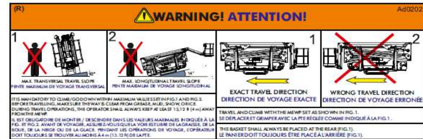
Figure 60 : pentes maximales pour translation.
